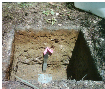
Figure 9. Exemple de mini fosse excavée
