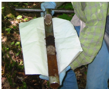
Figure 11. Carottier à côté ouvert à poignée transversale avec échantillon de sol
