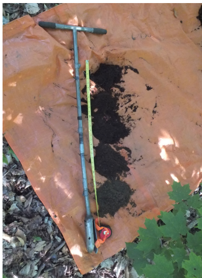
Figure 12. Tarière et profil de sol excavé
