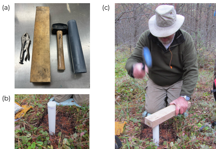
Figure 10. Carottage par tube (a) Équipement de carottage par tube. (b) Tube inséré dans l'excavation de la motte de terre. (c) Carottage
