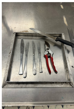
Figure 5. Matériel d'échantillonnage du gabarit LFH.
